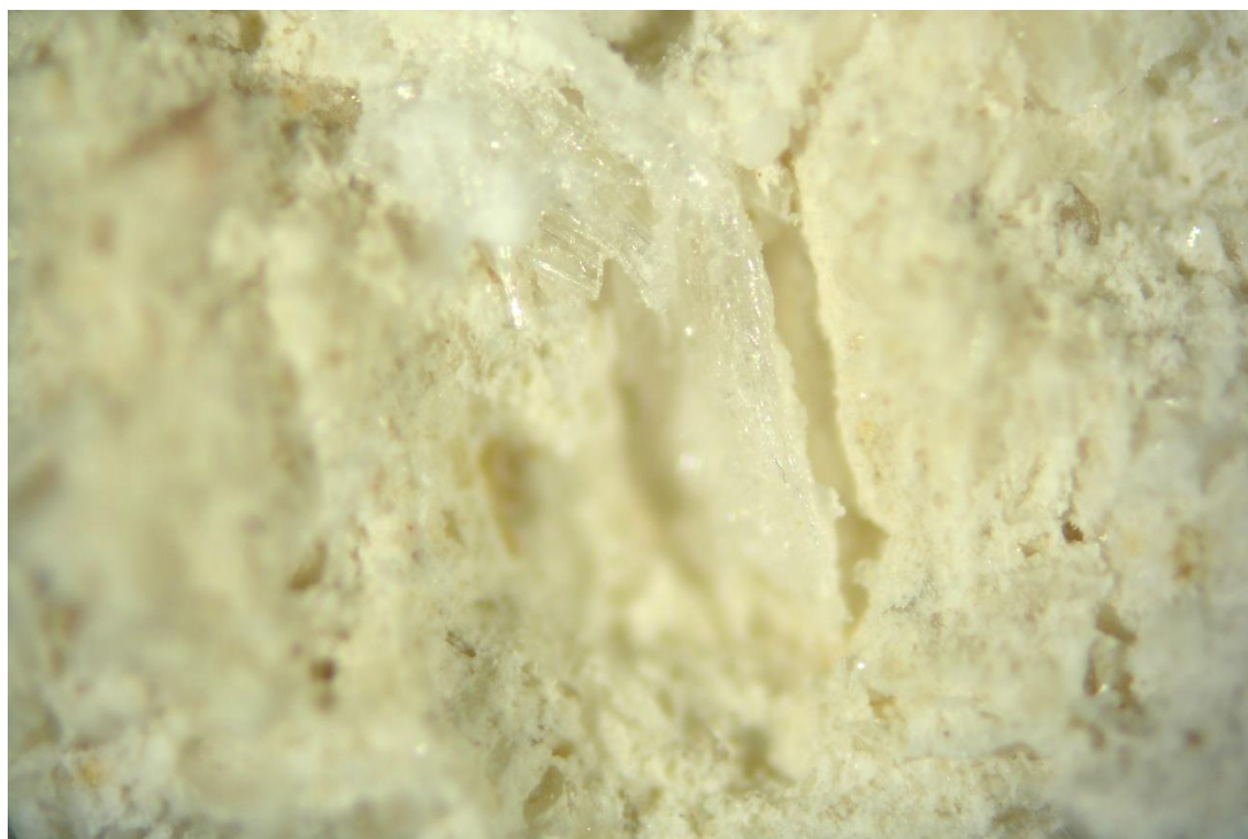
Mikrofotografia powierzchni próbki w świetle odbitym. Widoczne bezbarwne, włókniste ziarna. Powiększenie x85. Fot. E. Jeżewska.
