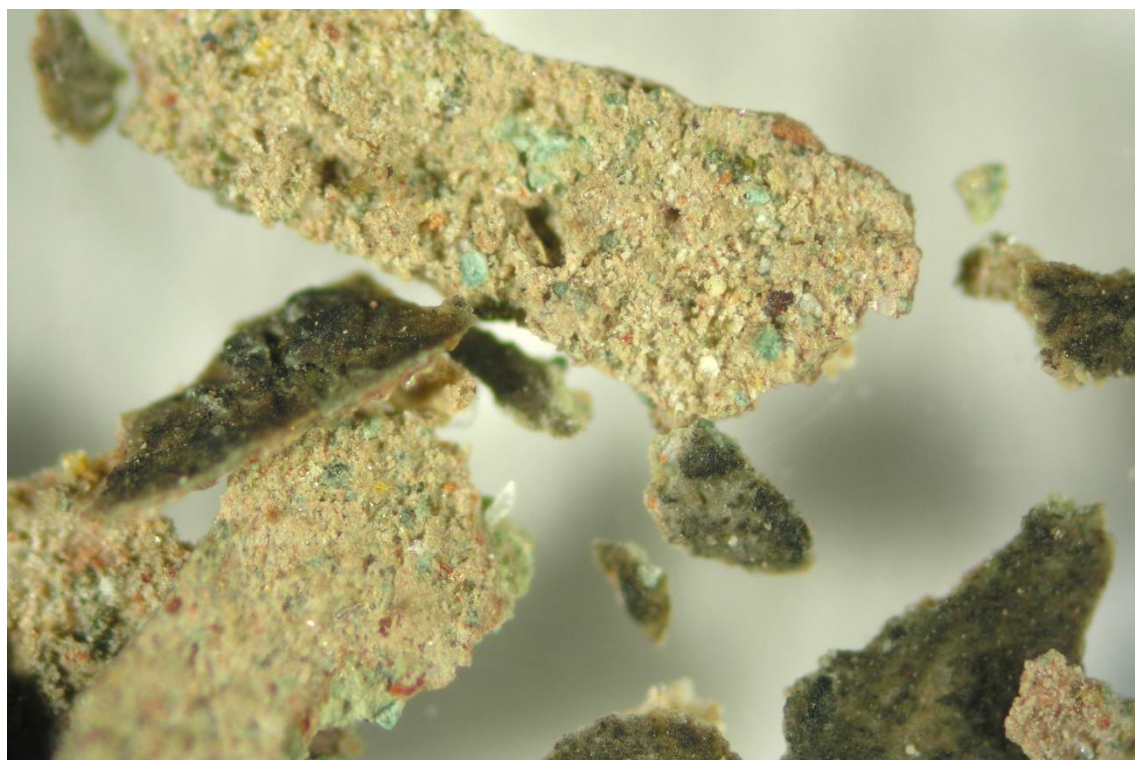
Mikrofotografia próbki w świetle odbitym. Widoczne zabrudzenie powierzchni warstwy malarskiej. Powiększenie x85. Fot. E. Jeżewska.
