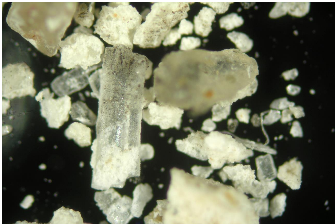
Mikrofotografia powierzchni próbki w świetle odbitym. Widoczne podłużne, bezbarwne ziarna o pokroju słupkowym. Powiększenie x85. Fot. E. Jeżewska.
