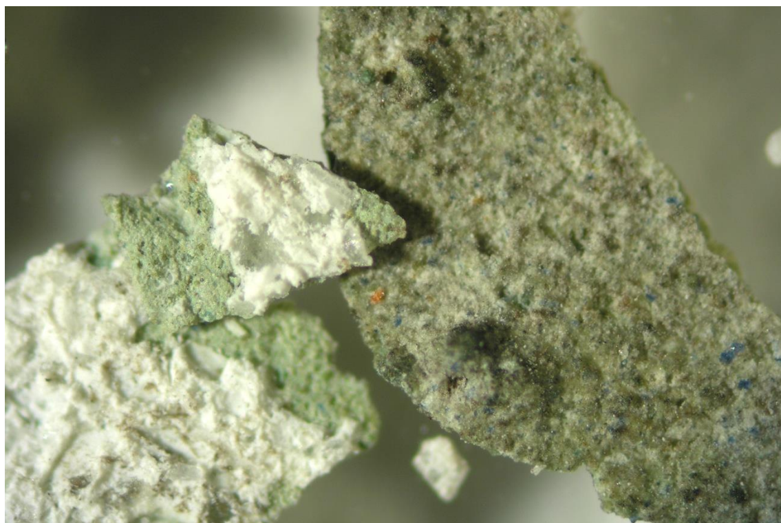
Mikrofotografia próbki w świetle odbitym. Po prawej stronie widoczny okruszek ukazujący strukturę powierzchni warstwy malarskiej. Warstwa jest pociemniała, poszarzała, widoczne pojedyncze ziarna błękitu. Jak pokazuje lewa strona fotografii warstwa zieleni jest intensywniejsza i zawiera większe skupiska błękitno zielone. W obrębie warstwy intonaco widoczne podłużne, bezbarwne ziarna. Powiększenie x85. Fot. E. Jeżewska.
