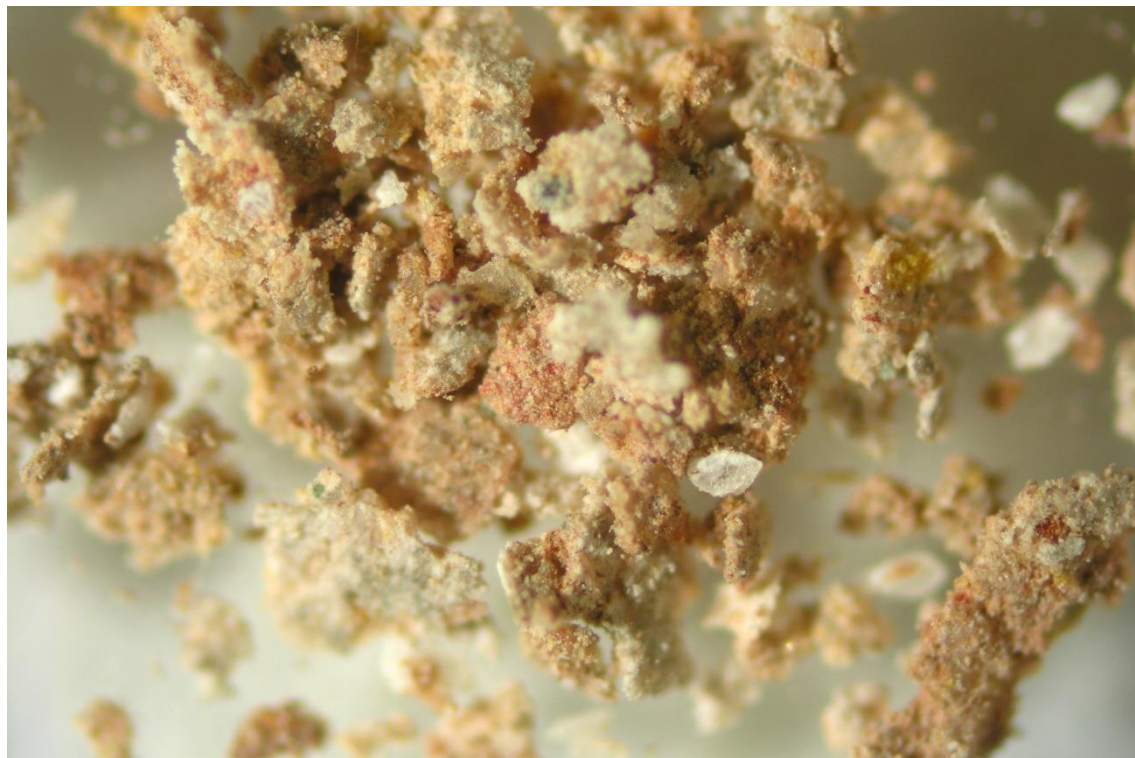
Mikrofotografia próbki w świetle odbitym. Widoczne drobne skupiska żywej czerwieni. Powiększenie x85. Fot. E. Jeżewska.
