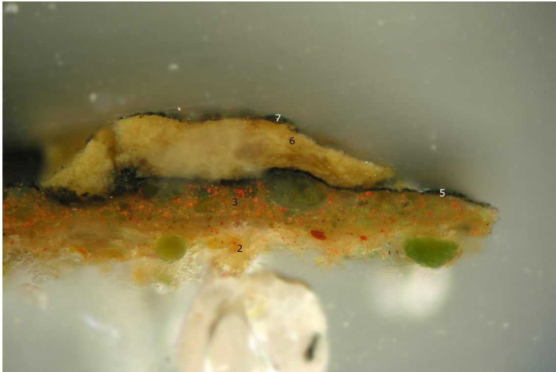
Przekrój stratygraficzny próbki w świetle odbitym. Powiększenie x420. Fot. E. Jeżewska.
