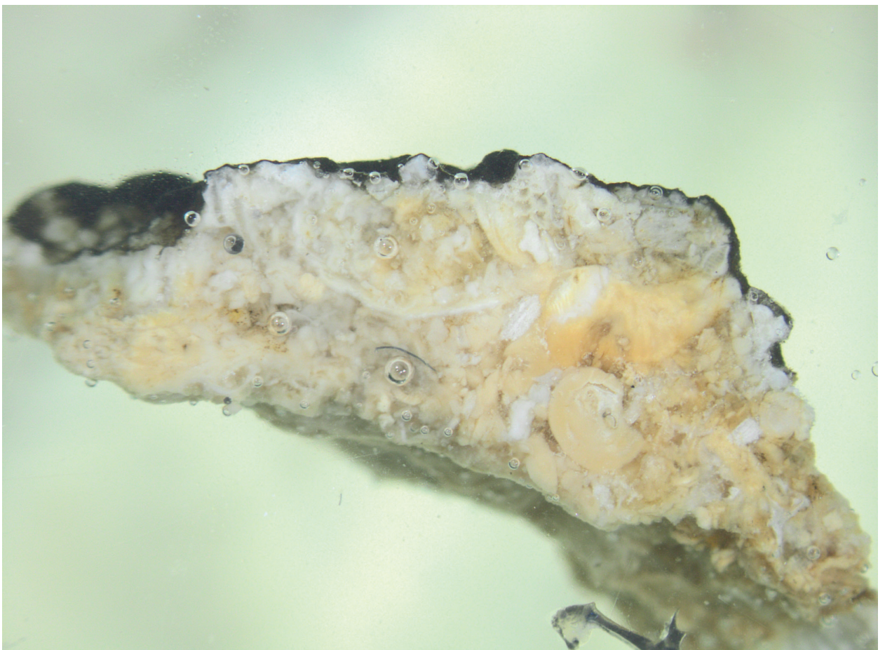
Fotografia przekroju poprzecznego próbki, powiększenie 13,5x. Cyframi oznaczono kolejne warstwy.
