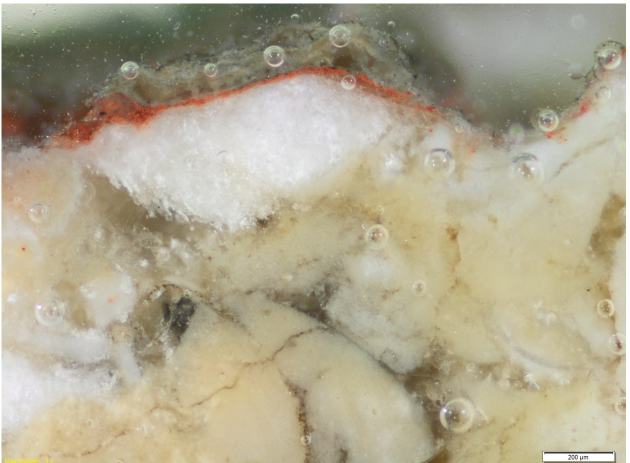
Fotografia przekroju poprzecznego próbki, powiększenie 40x. Cyframi oznaczono kolejne warstwy. Obszar 2 (analizy SEM-EDS).
