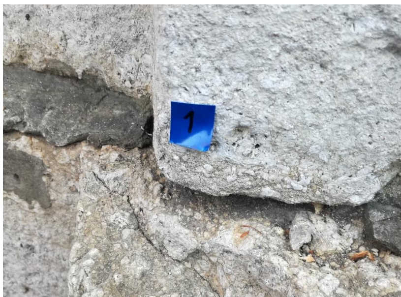
Fot. 4. Miejsce pobrania próby do badań petrograficznych (zał. 3, próba 1 W). Cokół pld. – zach.
