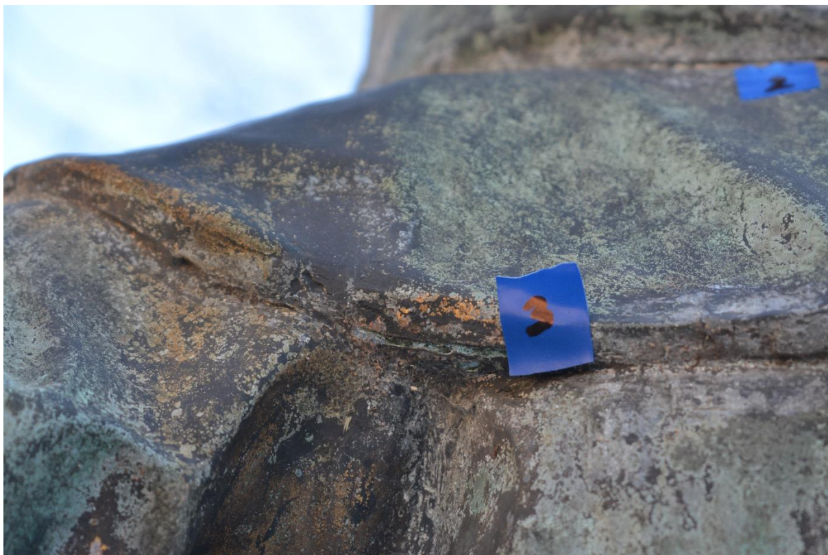
Fot. 59. Widoczna warstwa czarna i złota na szatach figury, czarne nawarstwienia oraz białe nawarstwienia świadczące o korozji cynku.
