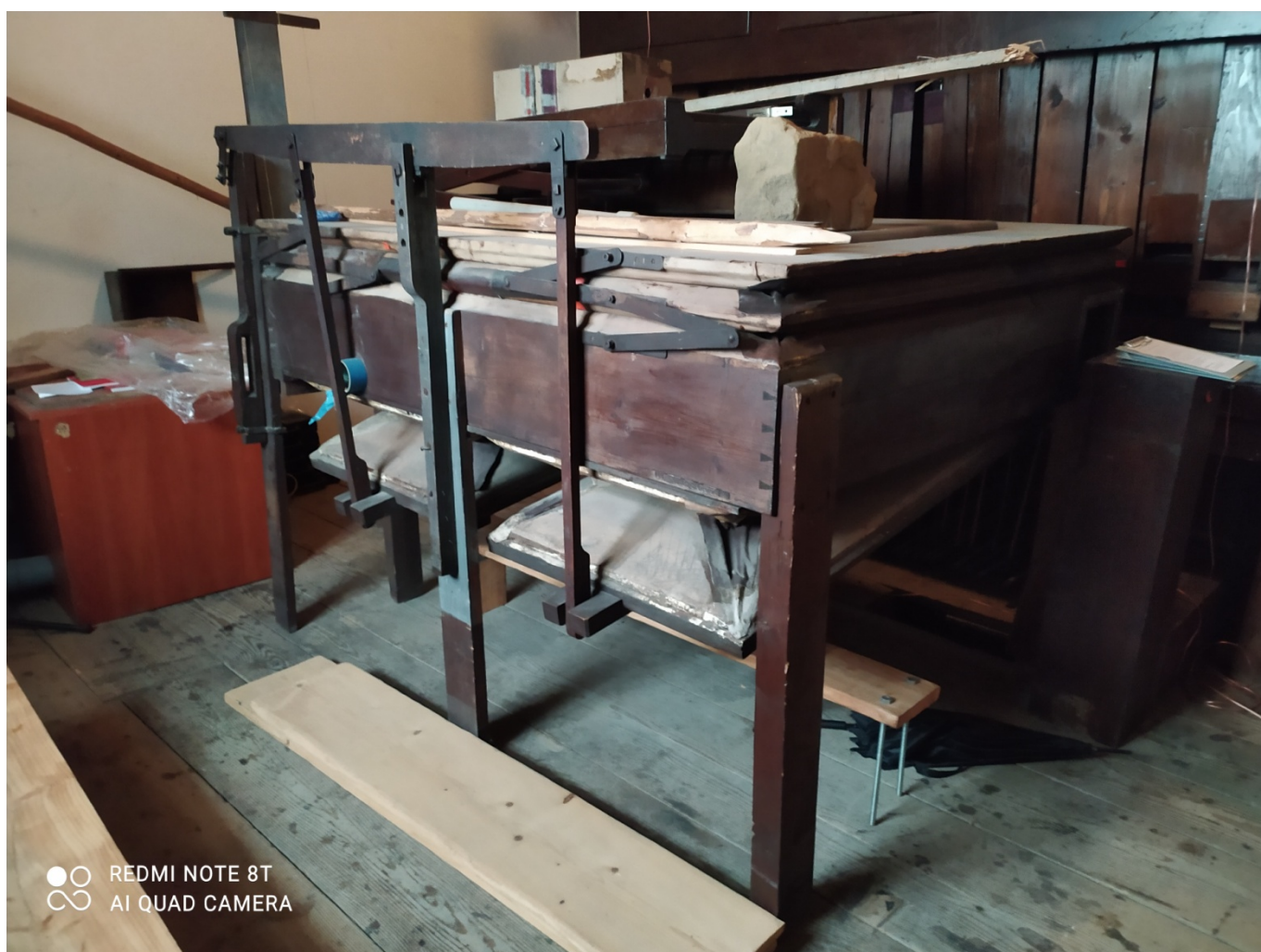
75. Miech magazynowy o dwóch wewnętrznych fałdach i dwóch klinowych podawaczach autorstwa Ignacego Żebrowskiego.
