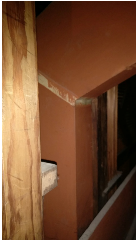
Kanały powietrzne prowadzące z miecha do II manualu (6.), do pedału (7.) i do I manualu (8.)
