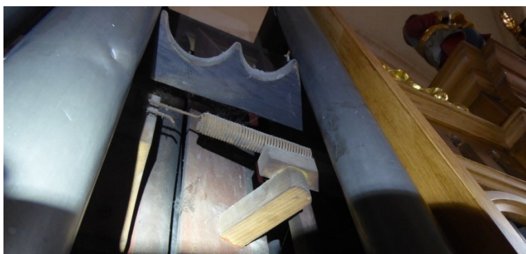
25. Sprężyna – istotna w mechanizmie szafy dla powrotu skrzydeł do pozycji zamkniętej.
