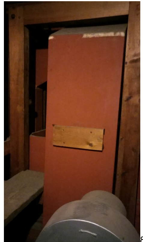
Kanały powietrzne prowadzące z miecha do II manualu (6.), do pedału (7.) i do I manualu (8.)
