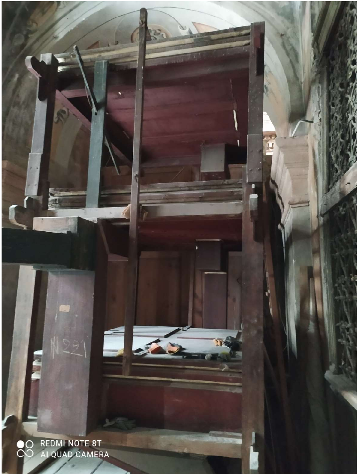
91. Potrójny miech horizontalny Ignacego Żebrowskiego w kościele pojezuickim we Lwowie. Widok od strony krótszego boku, z przyłączem dmuchawy.
