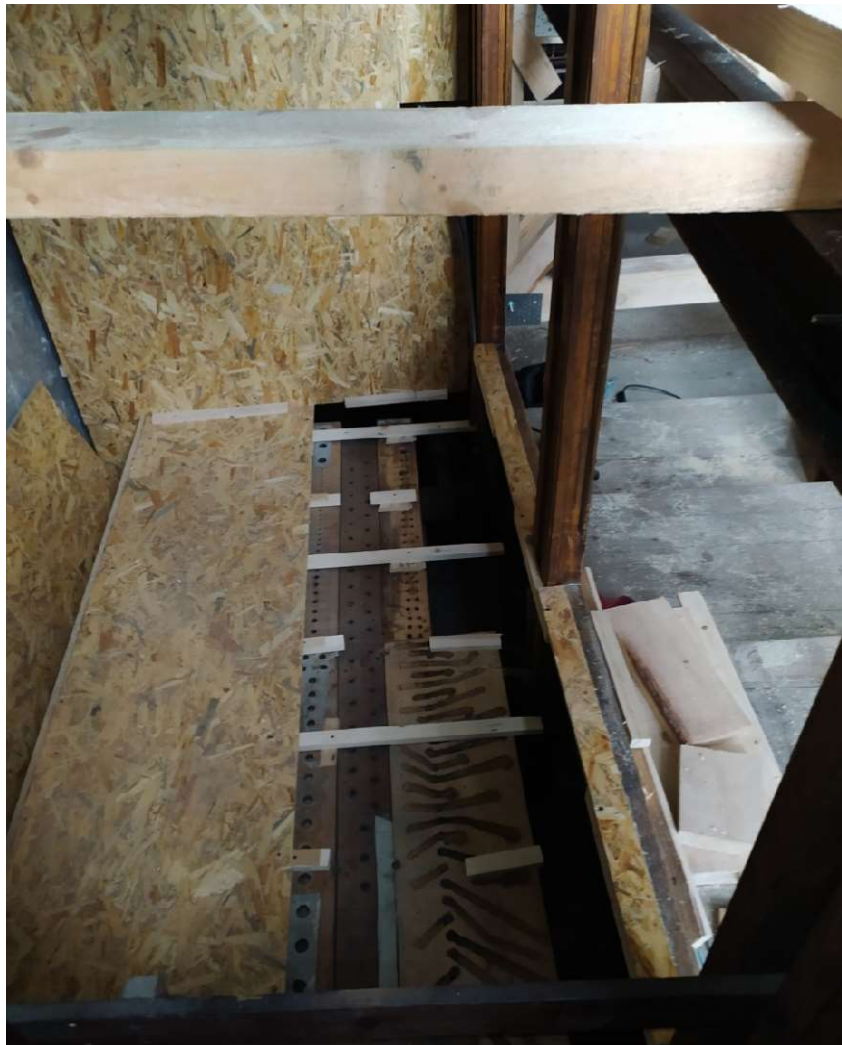
98. i 99. Wiatrownica II manualu (odsłonięty fragment) i przestrzeń potencjalnie przeznaczona na skrzydła szafy ekspresyjnej (powiększony kloz pierwszego głosu – nieoryginalny).
