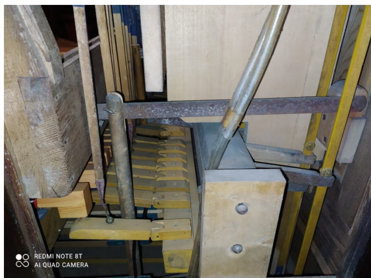
34. Dźwignia trytu szafy wewnątrz stołu gry i popychacz prowadzący w dół.
