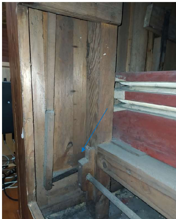
24. Dźwignia przekazująca ruch trytu do skrzydeł szafy.
