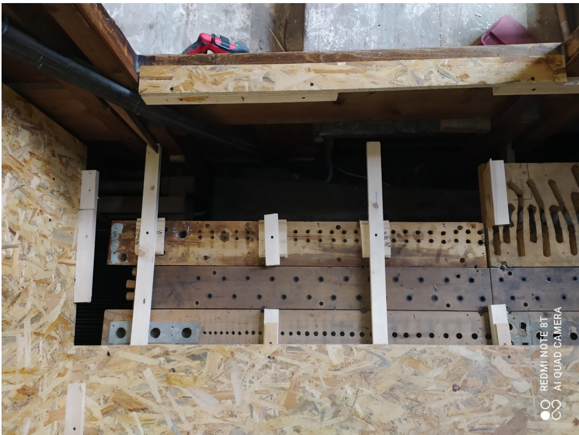
98. i 99. Wiatrownica II manualu (odsłonięty fragment) i przestrzeń potencjalnie przeznaczona na skrzydła szafy ekspresyjnej (powiększony kloz pierwszego głosu – nieoryginalny).
