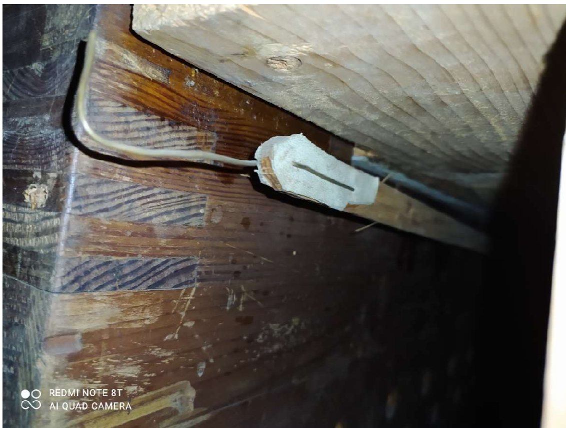
100. Abstrakt poziomy (wtórny) podpięty do mechanizmu połączonego z nieopisanym trytem w stole gry. Mechanizm szafy ekspresyjnej musiałby przebiegać taką drogą.
