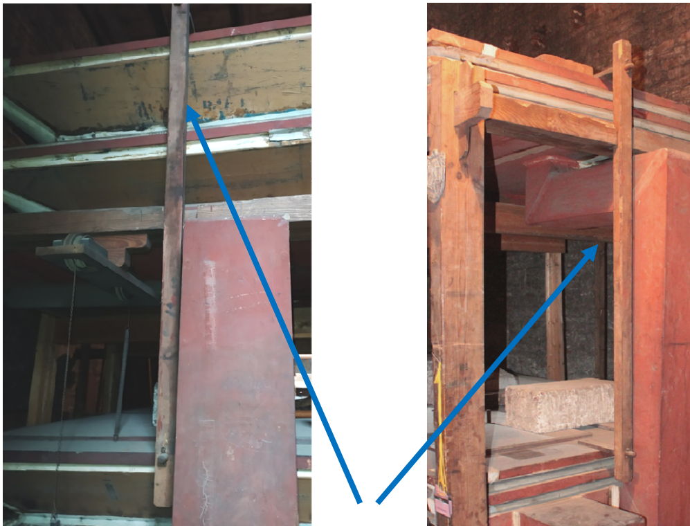
106. a i b) Miech w katedrze lwowskiej. Oryginalne drewniane listwy łącząca górne płyty miechów dolnego i górnego.
