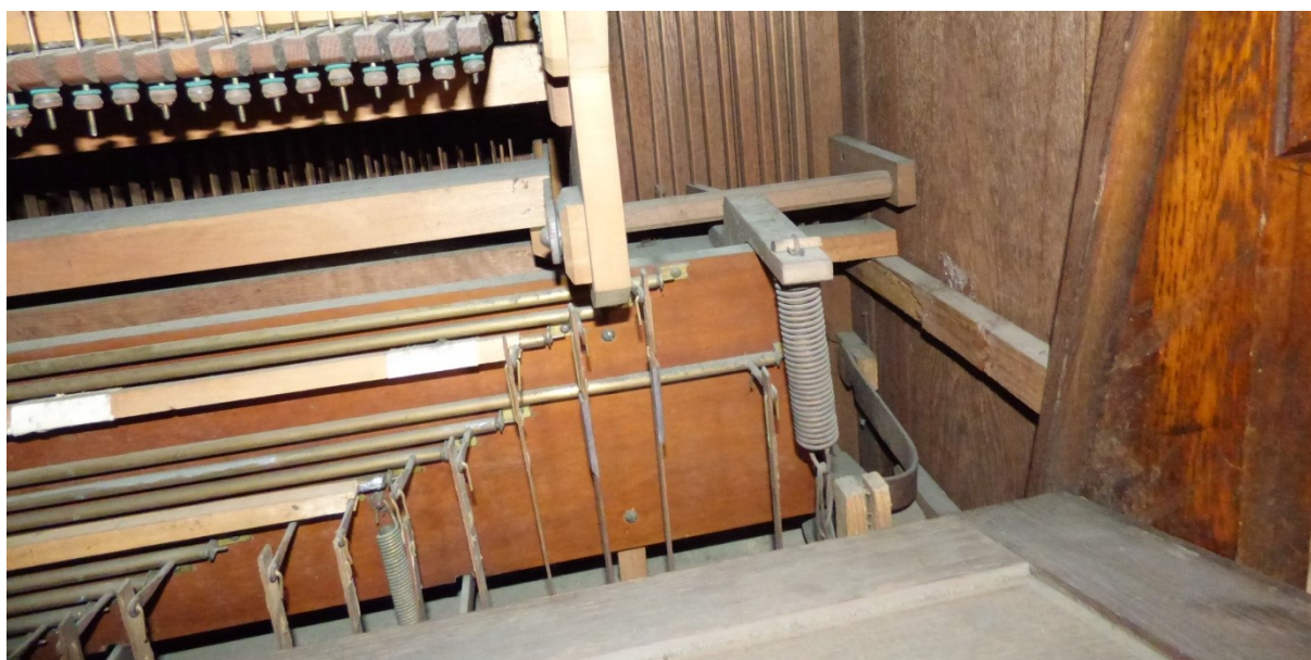
93. Dwie sprężyny do obsługi nieopisanej dźwigni o konstrukcji zróżnicowanej w stosunku do analizowanych polskich instrumentów. (PM 2018)
