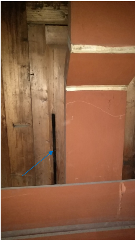
Kanały powietrzne prowadzące z miecha do II manualu (6.), do pedału (7.) i do I manualu (8.)
