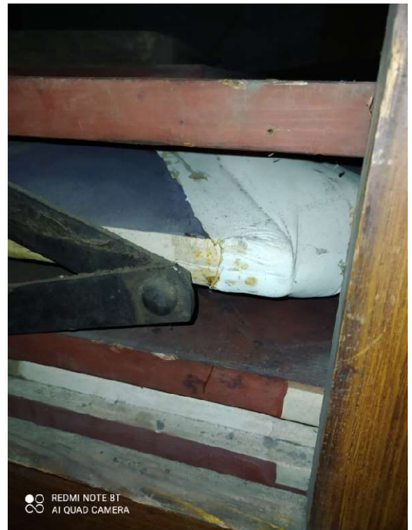
41. Główny miech pod powietrzem – obecnie rozkłada się tylko górna falda (zewnętrzna). Poniżej widok złożonej faldu wewnętrznej.
