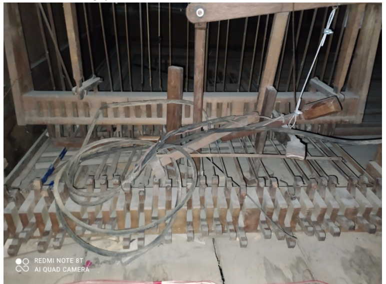
77. Traktura pedału i dźwignia szafy ekspresyjnej.
