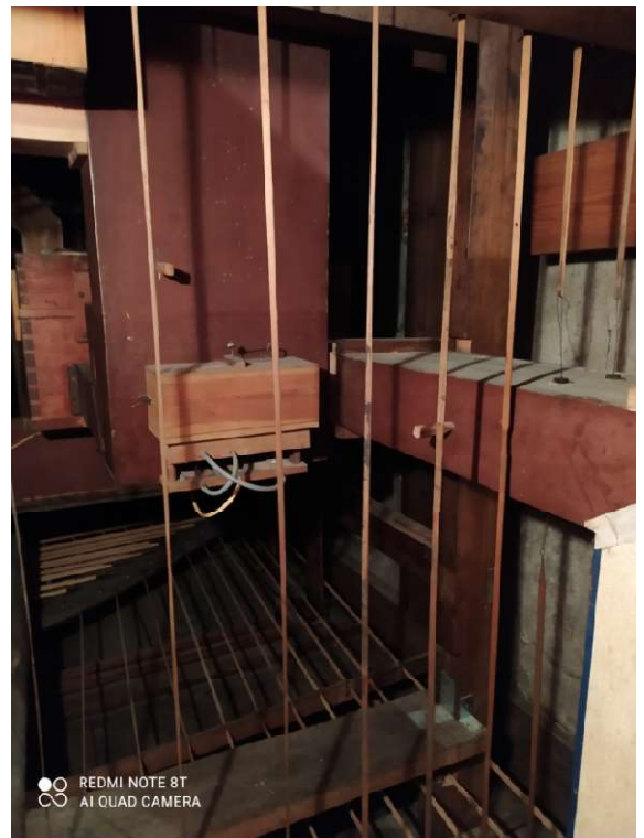
61. Oryginalny kanał pionowy prowadzący z miecha do II manualu.
