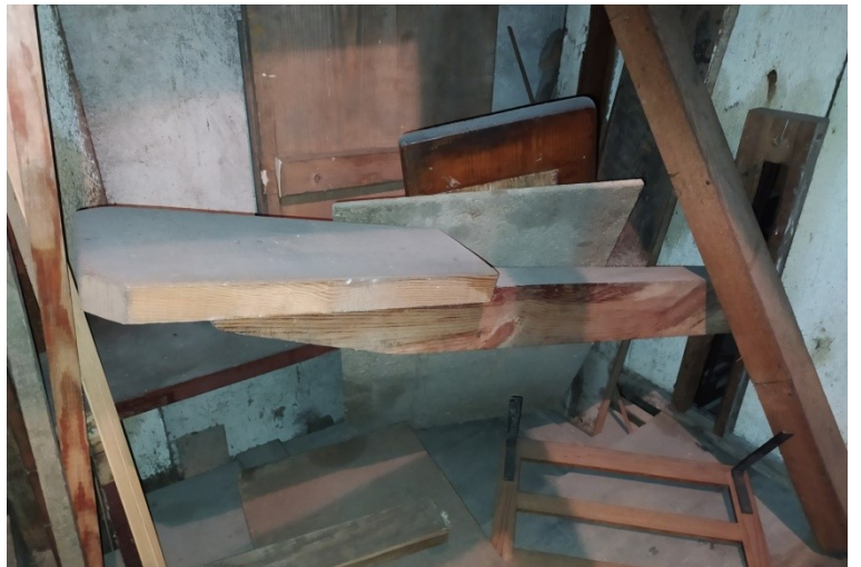
58. Wtórna dźwignia nożna do kalikowania.
