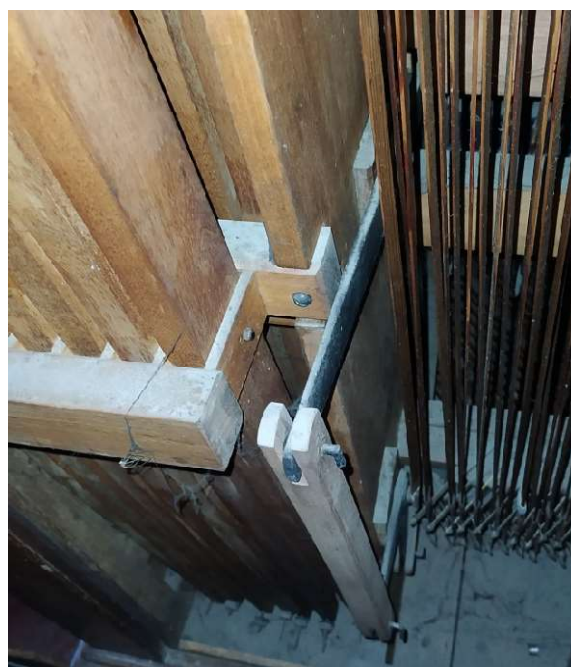
12. Dźwignia i kątownik przekazujący ruch trytu.
