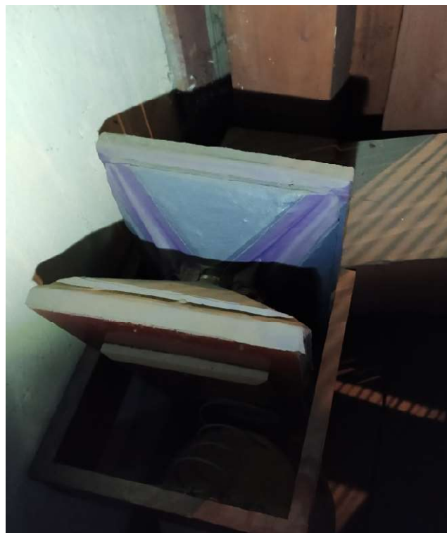
27. Dawny pionowy amortyzator na kanale II manuału. Obecnie element tremolo.
