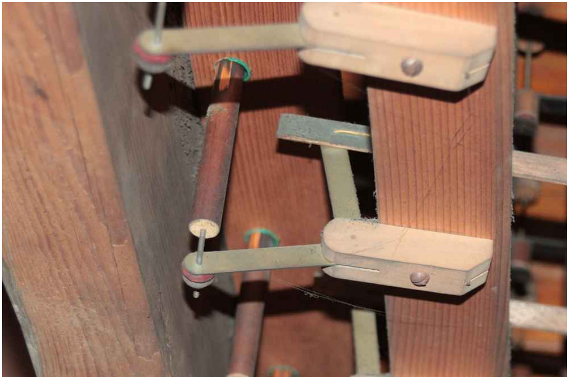
Widok detali Traktura rejestrowa, fragment
